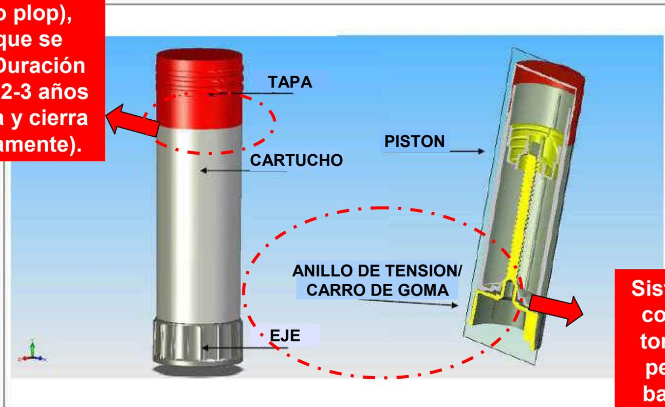
Sistema de carro con freno en el tornillo, que no permite que la barra se salga. Permite utilizar el producto hasta el final.
